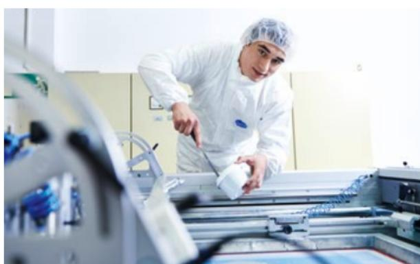
印制薄膜的丝网印刷机
